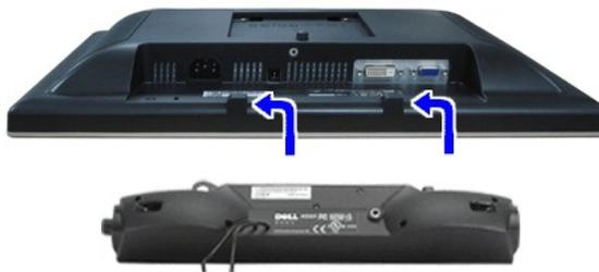
1. Trabajando desde la parte posterior del monitor, acople la barra de sonido alineando las dos ranuras con las dos lengüetas a lo largo de la parte posterior del monitor.
